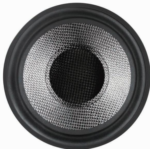
**エアロfoil・コーン：**新しいテクノロジーが誕生すると、エンジニアリングでは、数年前には不可能だったことができるようになることがあります。その好例がエアロfoil低音コーンです。私たちは、先進のコンピュータ・モデリングと新しいシタックテック素材を芯に用いることでコーンの厚さに変化を持たせ、剛性が最も必要とされる場所を最大にすることに成功。このように、断面形状が最適化されたことで、コーンのピストン挙動は可聴域のさらに上まで広がり、より正確で、ダンピングの効いた、臨場感あふれる低音域が再生されます。
