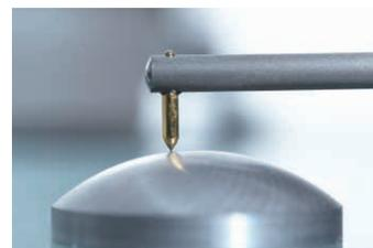
ダイヤモンドの誕生。上の写真：各ドームは、レーザーで精密にカットされ、表面にある凸凹を取り除き、形が均一かどうか測定します。右の写真：プラチナで保護コーティングをしてでき上がったドームのセット。
