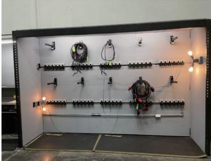
オーディオクエストが所有するバーンインシステム。時に上級モデルのケーブルは36時間以上かけてバーンイン処理を行なっている
