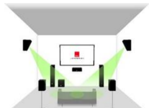
横壁面に設置し、7.1chのサラウンド(サイド)スピーカーとして。
