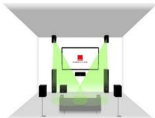
正面壁面に設置し、フロント・ハイトスピーカーとして。
