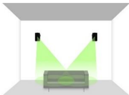
後方壁面に設置し、サラウンドバック、リアハイトスピーカーとして。
