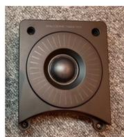
■ **新規設計ドームトゥイーター**：新規設計で従来の口径28mmから29mmに大口径化、磁気回路も新規設計。また取付けフランジが上記のようにアルミダイカストにグレードアップしています。大型化することで高域内の最低域をふくよかにし、ミッドバスとのつながりを自然に再生します。
