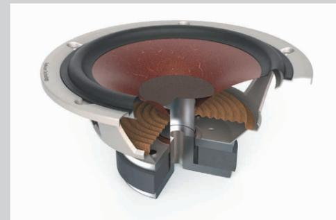
SPEKTOR でもウーハーの振動板として採用されているのは、DALI のトレードマークとも言えるウッド・ファイバー・コーンです。このユニークなコーン素材は、きめ細かなパルプ繊維と木繊維の混合物で形成されています。ウッド・ファイバー・コーンは、ウーハーの振動板として最適な軽さと強度を持つだけでなく、ランダムな木繊維によって、あえてコーン表面を凹凸のある不均一な状態とすることで、コーン自体からの不要な共振を最小限に抑え、良好な低域特性を実現するという役割があります。さらに、SPEKTOR のために、低損失サスペンション、フレーム、磁気回路等、すべての要素を改良し、モデルに応じた最適化を行いました。
