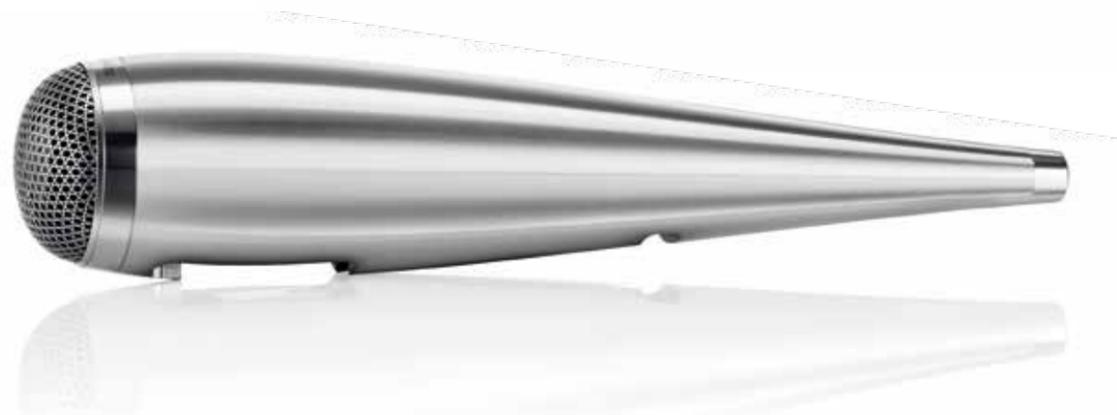
ソリッドボディ・トゥイーター：象徴的なソリッドボディ・トゥイーター・オントップ・ハウジングの最新バージョンは、延長されたフォルムとより長いチューブローディング・システムを採用し、いっそう自然で開放的な高音域を実現しています。また、従来同様に、一塊のアルミニウム・ブロックから丁寧に削り出されたデカップリング・ハウジングは、共振を効果的に抑制します。
