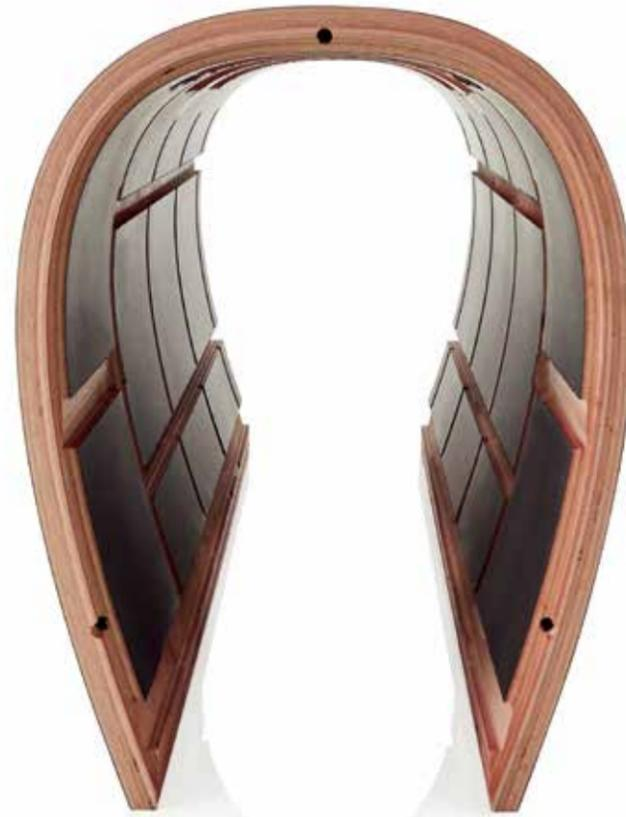
リバースラップ・キャビネット：新しい800 Series Diamondでは、シリーズ最小モデルの805 D4を含むすべてのスピーカーに、リバースラップ・キャビネット技術が採用されています。リバースラップ・キャビネットは、伝統的なスピーカーボックスの代わりに、カーブした一枚の積層合板で作られており、エンクロージャーの後部には部品を挿入するための最小限の隙間だけが設けられています。これにより、機械的な共振を防ぎ、バップル効果を抑えて音の拡散性を向上させています。
