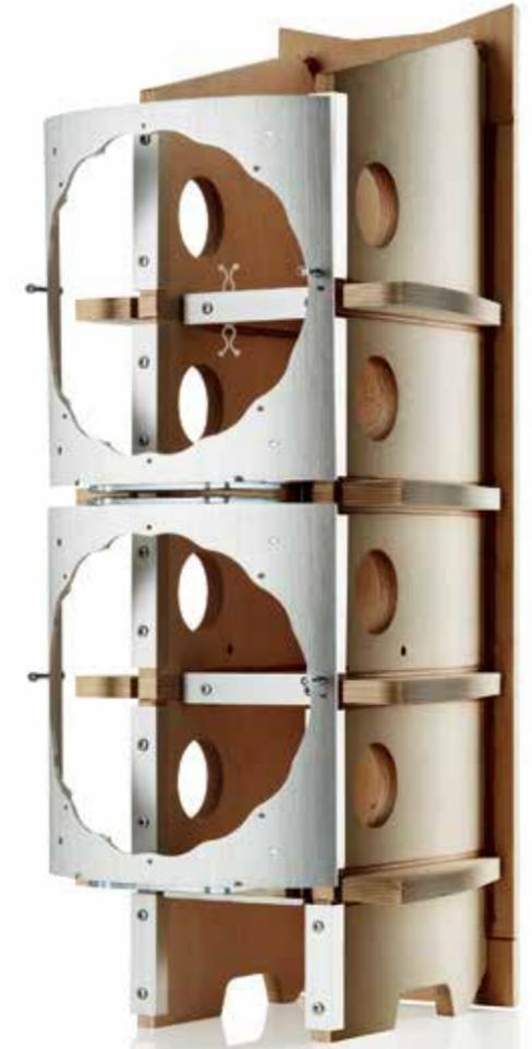
マトリクス：マトリクスアセンブリは、連結された複数のパネルを用いてスピーカー・キャビネットを内側から全方向に対して支持・補強することにより、共振を抑えてよりリアルなサウンドステージを実現します。新しい800 Series Diamondのすべてのモデルは、アップグレードされたマトリクスアセンブリを採用しており、強固な合板構造とアルミニウム・ブレイシングを組み合わせ、重要なストレスポイントを補強しています。
